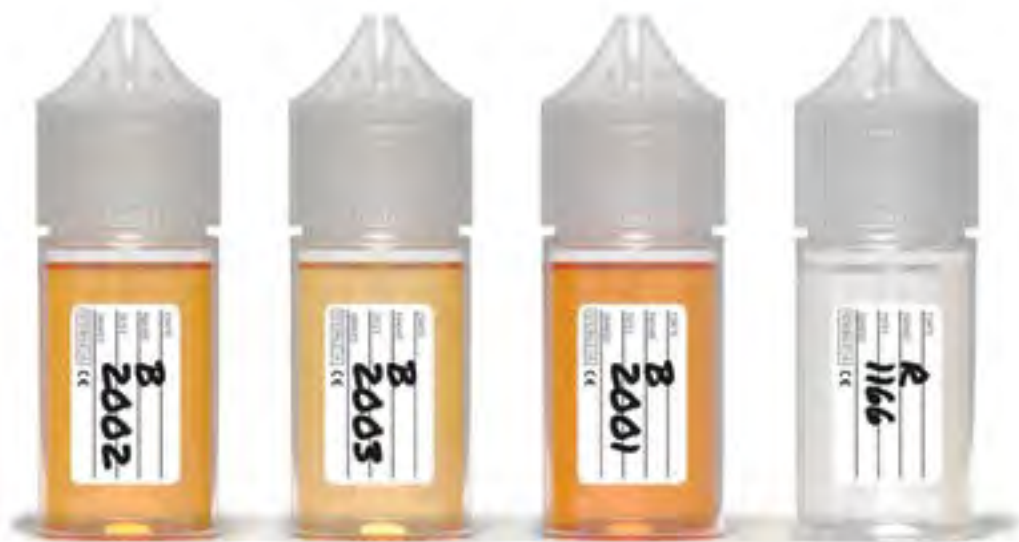
Alchem NicSelect尼古丁3.0(样品R 1166)与其他EP尼古丁样品之间的对比。 将样品在室温下暴露于光和空气中三周——Alchem NicSelect尼古丁3.0（最右侧）保持透明和稳定，而其他样品则迅速氧化，变黄，然后由黄变为棕色。
