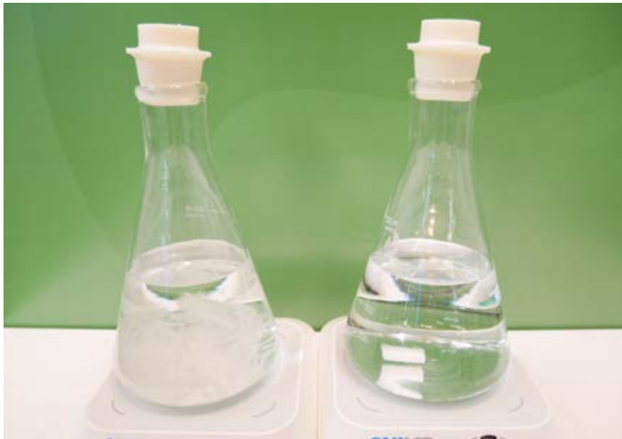
浸入自来水中时，Greenbutts衬底就开始分散(左图)，而传统的CAT烟头完全不受影响。
