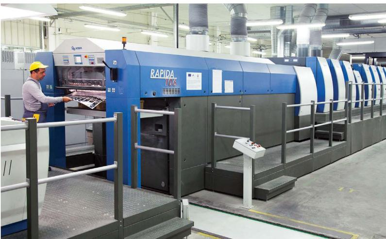
尤里·加加林的KBA Rapida 106，一款带有集成离线冷箔工具的14节胶印机
