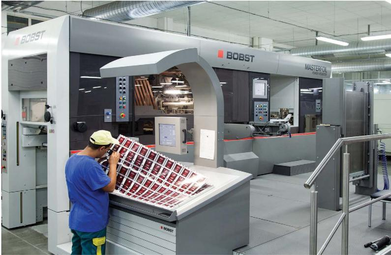
尤里·加加林的最新一代热箔机——Bobst Masterfoil Autoplatine
